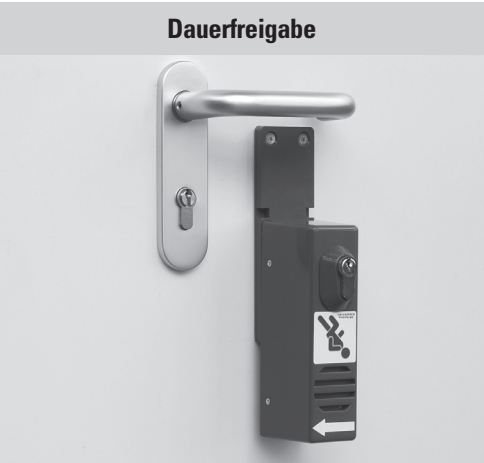
Mit dem Geräteschlüssel kann der Türwächter durch Drehung um 180° alarmfrei in eine Dauerfreigabeposition gebracht werden. In dieser Stellung ist die Tür normal zu begehen.
