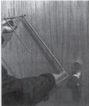
Vor dem Einsatz wird der Hebelarm des Lockoff in seiner Länge justiert. Dabei gilt es, das Gestänge des Lockoff von der Mitte der Spion-Bohrung an, entsprechend der Entfernung zum Türdrücker, einzustellen, damit der Türdrücker tief genug gedrückt werden kann.
