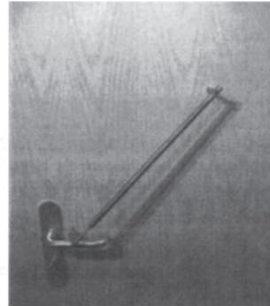
Das Justieren des Hebelarms vor der Tür ist sehr wichtig. Wurde er zu kurz eingestellt, rutscht der Hebel vom Drücker ab, bevor er tief genug gedrückt wurde. Ist er zu lang, kann die Kraft nicht ausreichend übertragen werden. Bei einer Fehljustierung ist das in die Tür eingebrachte Lockoff problemlos wieder herausziehbar und neu zu justieren.
